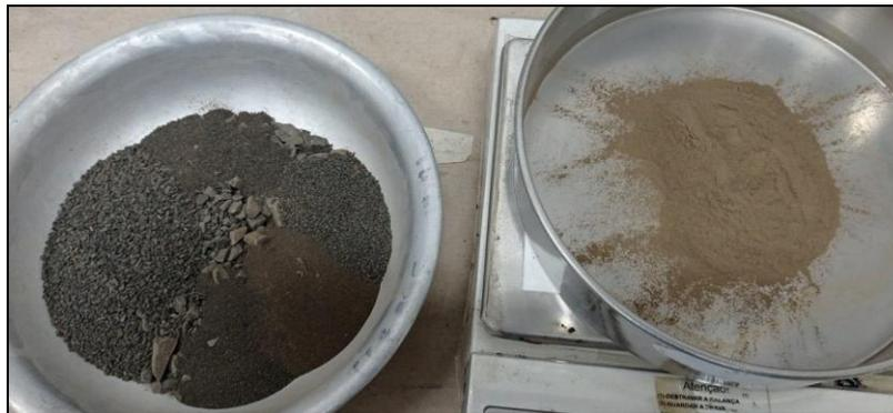
Figura 6. Amostra de agregados após extração de CAP (DOBES, 2023).
