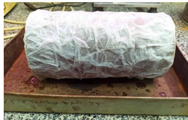
(b) Corpo de prova em processo de umedecimento
