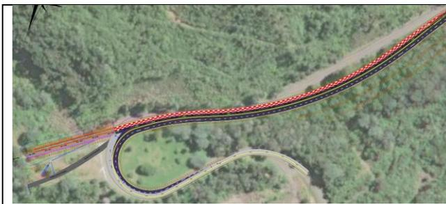
Figura 3. Planta baixa da área de escape projetada. Fonte: Os autores, 2024.
