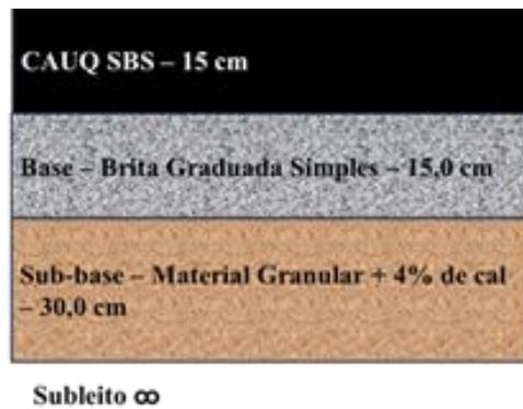
Figura 2. Estrutura de pavimento do projeto (DER-DF, 2022).
