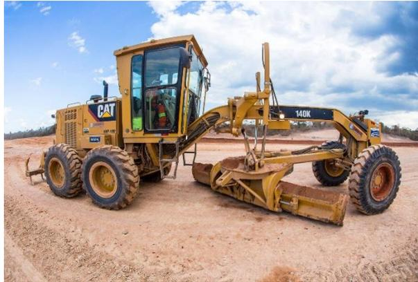
Figura 4: Motoniveladora, ou Régua Niveladora. Fonte: <https://www.lafaetelocacao.com.br/produto/motoniveladora/>
