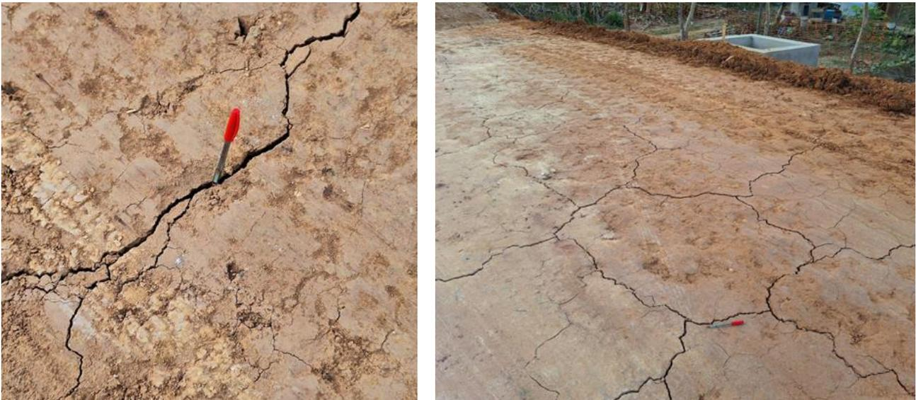
Figura 8. Formação de trincas em um solo LG’ (AUTOR, 2024).
