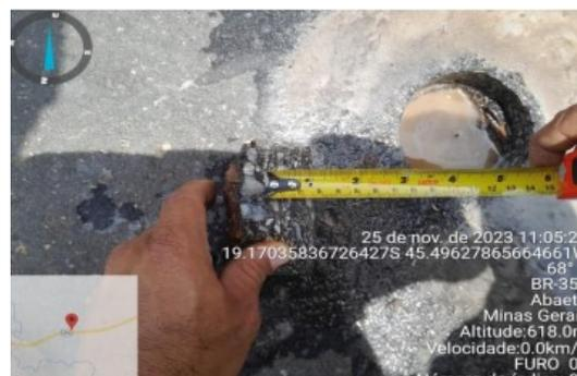
Figura 4. Controle da espessura dos corpos de prova com utilização de trena (OS AUTORES, 2023)
