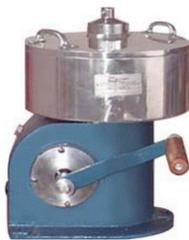
Figura 7. Aparelho Rotarex (<https://renacerindustriacatalogo/rotarex-manual - 2023>)
