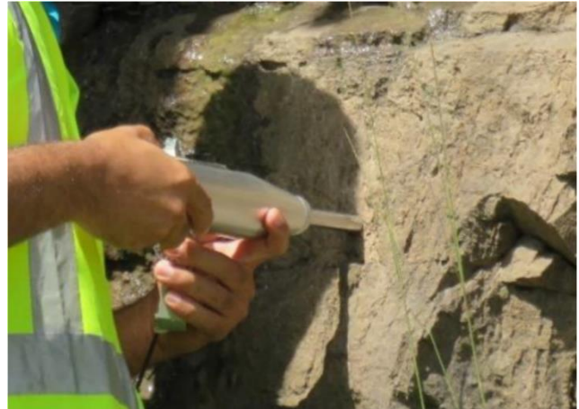
Figura 3. Medição da orientação das fraturas com bússola profissional de geólogo (GEOPHI ENGENHARIA, 2023). Figura 4. Ensaio com Martelo Schmidt para medição de rebote e avaliação da qualidade mecânica do maciço (GEOPHI ENGENHARIA, 2023).
