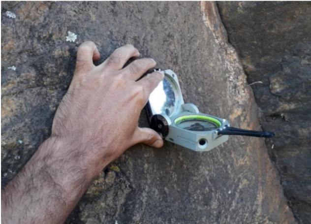
Figura 3. Medição da orientação das fraturas com bússola profissional de geólogo (GEOPHI ENGENHARIA, 2023). Figura 4. Ensaio com Martelo Schmidt para medição de rebote e avaliação da qualidade mecânica do maciço (GEOPHI ENGENHARIA, 2023).
