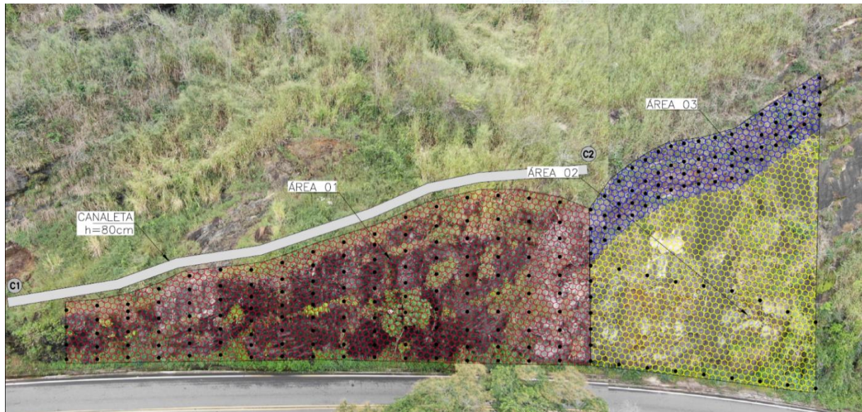
Figura 8. Mosaico esquemático do sistema de estabilização do talude (GEOPHI ENGENHARIA, 2023).
