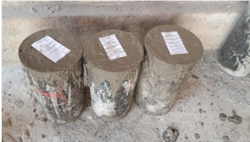
Figura 3 – Corpos de prova moldados pela construtora.
