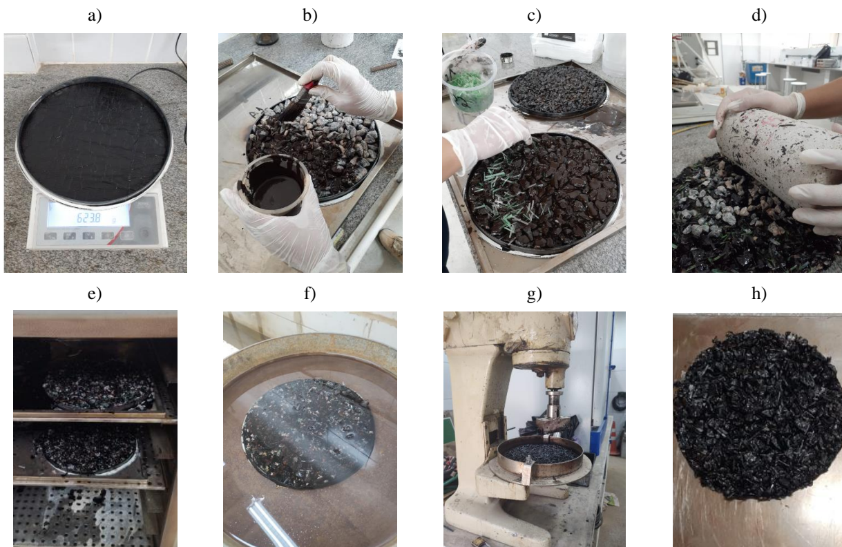
Figura 5. Procedimentos para realização dos ensaio WTAT.
