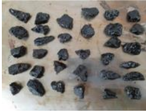
Figura 7. Resultado do ensaio de adesividade.
