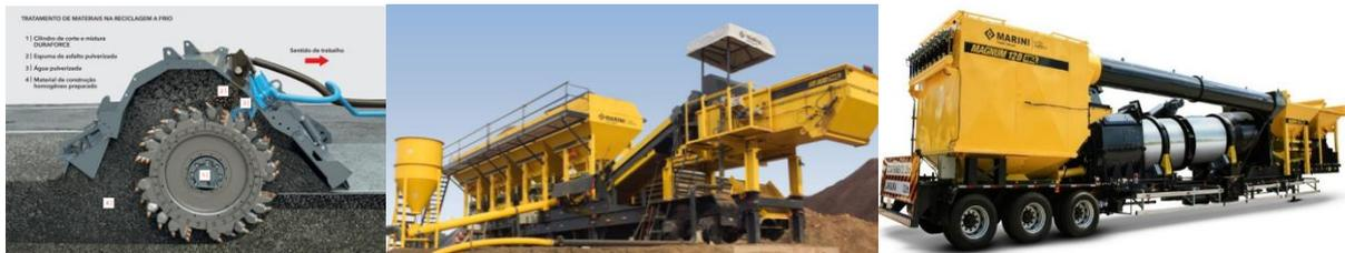
Figura 3. Reciclagem com RPA: (a) - Tratamento de materiais na reciclagem a frio, (b) Usina móvel do tipo MARINI 600 US para mistura a frio, (c) Usina móvel para misturas a quente; volumétrica. (MARINI, 2018 e WIRTGEN, 2020)
