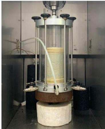
Figura 2. Corpo de prova para o ensaio de SSR
