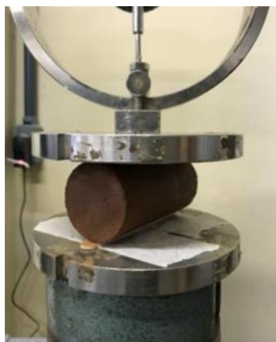
Figura 5. Ensaio de compressão diametral (AUTORES, 2024)
