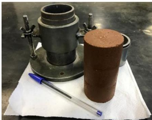
Figura 4. Molde tripartido utilizado para moldagem de corpos-de-prova (AUTORES, 2024).
