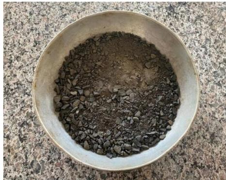
Figura 3. Material granular após a extração de ligante. (MOIZINHO, 2024).
