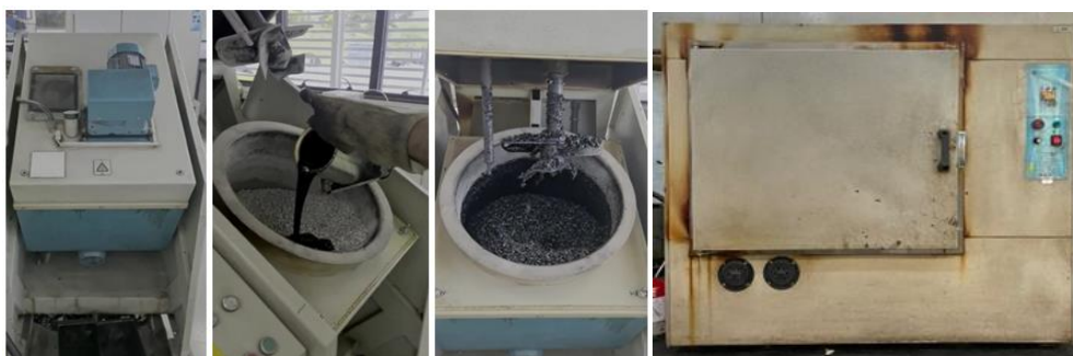
Figura 10 – Preparo da mistura asfáltica de CPA.
