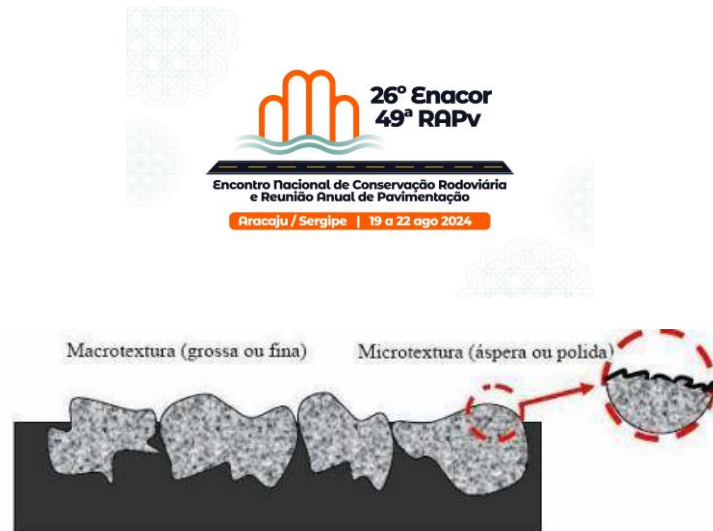
Figura 1. Macrotextura e microtextura em pavimentos (PERES et al. , 2006)
