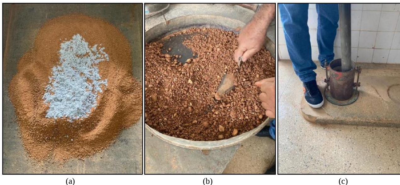
Figura 3. Compactação das misturas: (a) Solo + Dynabase®; (b) Umedecimento e homogeneização da amostra; (c) Compactação (Autores, 2023).
