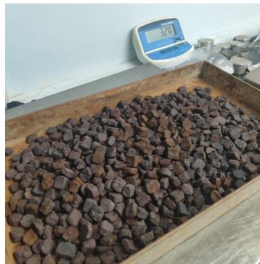
Figura 9. Agregado após calcinação em 1100°C em forno mufla.
