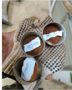
Figura 4. Amostra dos materiais para o DRX.
