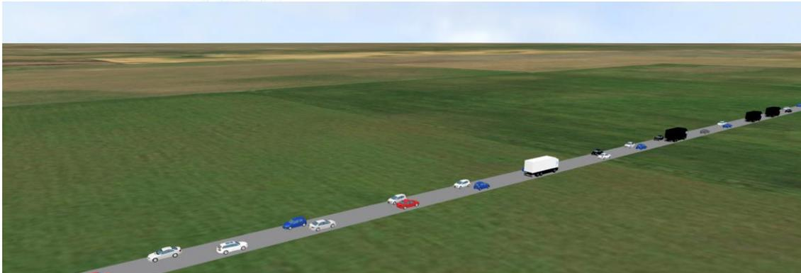
Figura 4 - Simulação do VISSIM para pista simples com fluxo livre em VMD de 40.000 por faixa
