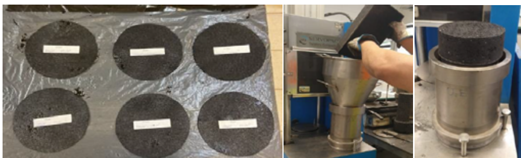
Figura 17 – Compactação da primeira camada de mistura asfáltica Faixa III DNIT.
