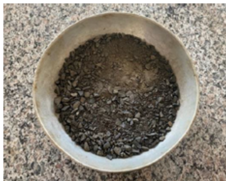
Figura 3. Material granular após a extração de ligante. (MOIZINHO, 2024).
