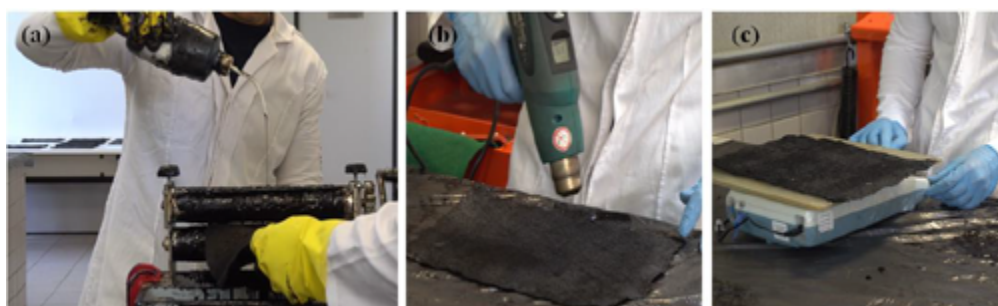
Figura 5 – (a) Impregnação da emulsão com o geotêxtil; (b) Secagem do geotêxtil não tecido com o soprador de ar quente; (c) Pesagem do geotêxtil não tecido impregnado.
