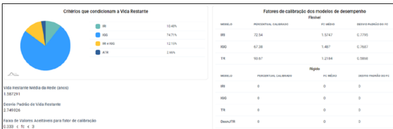
Figura 6. Exemplo da tela do SGP-DNIT com a síntese da recalibração dos modelos e cálculo da VR.
