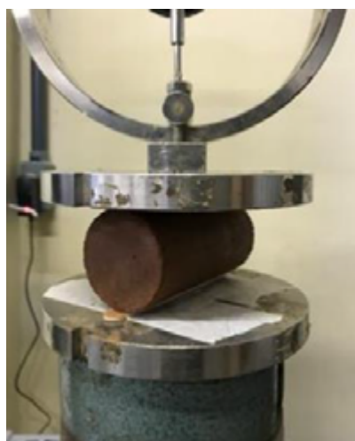
Figura 5. Ensaio de compressão diametral (AUTORES, 2024)
