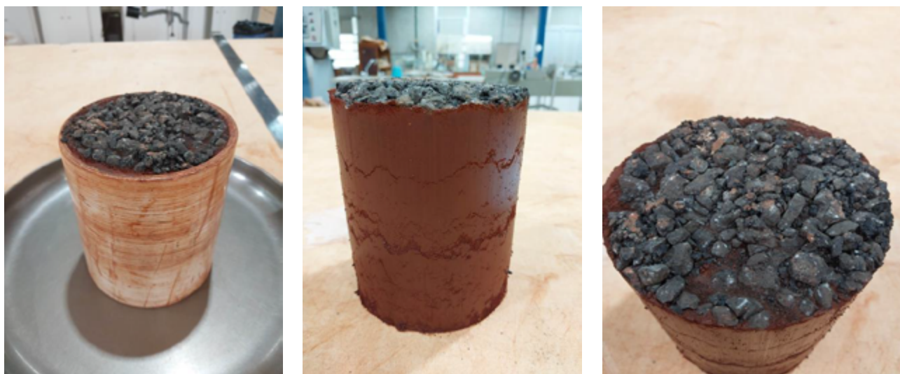
Figura 3. Corpo de prova da mistura S-1 (LG') melhorada com 4% de cimento, compactado na energia normal, com tratamento primário por agulhamento na superfície, utilizando agregados grossos de fresado asfáltico (Acervo do primeiro autor)
