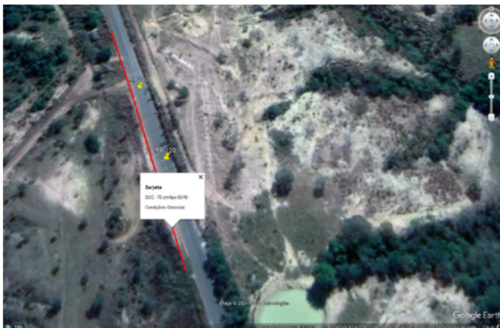
Figura 8 - Comparação dos levantamentos de Drenagem e Patologias no pavimento. Fonte: Os Autores
