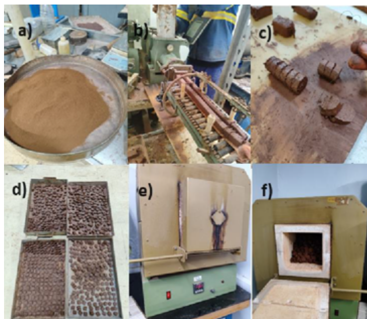
Figura 1. Equipamentos utilizados na extrusão e calcinação. a) Forma para mistura; b) Maromba elétrica; c) Fio de Nylon; d) Formas de metal para secagem; e) e f) Forno Mufla para calcinação à 1100C.
