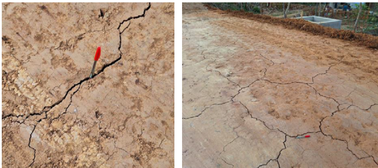
Figura 8. Formação de trincas em um solo LG’ (AUTOR, 2024).
