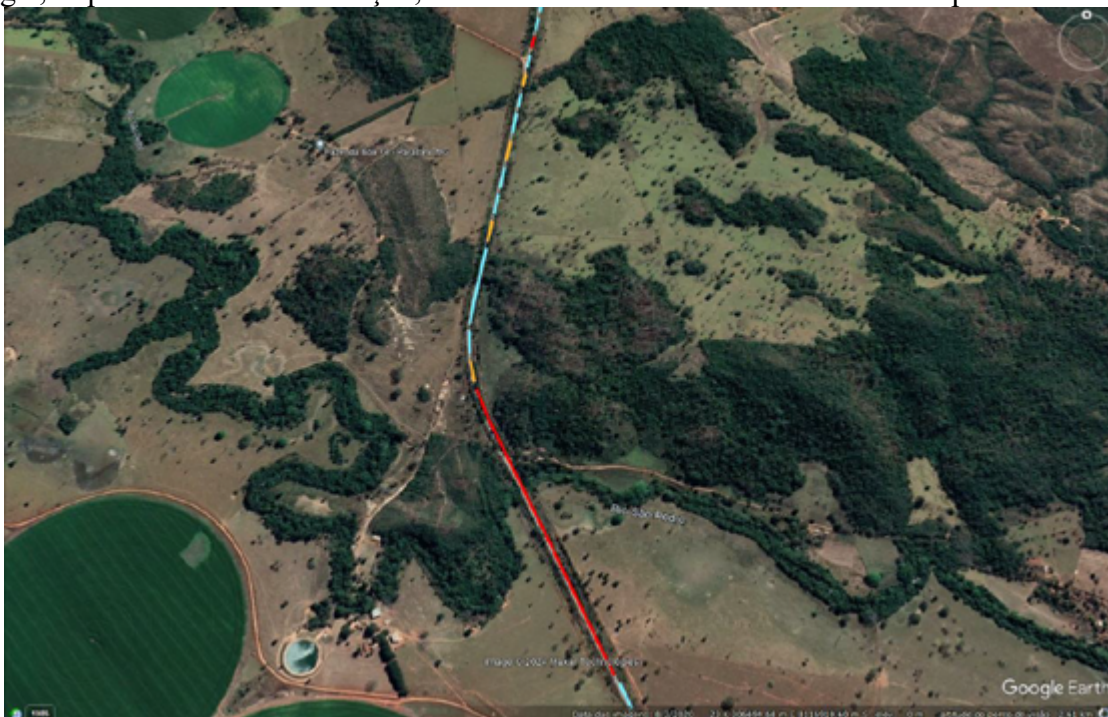
Figura 7 - Levantamento de segmentos similares, em vermelho: mau, laranja: Regular, Azul: Bom. Fonte: Os autores
