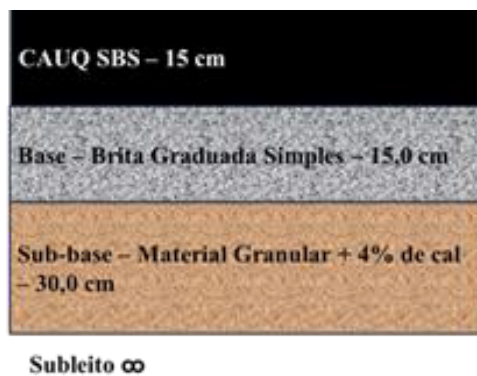
Figura 2. Estrutura de pavimento do projeto (DER-DF, 2022).
