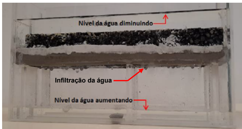
Figura 15 – Infiltração da água praticamente instantânea nos corpos de prova sem geotêxtil.
