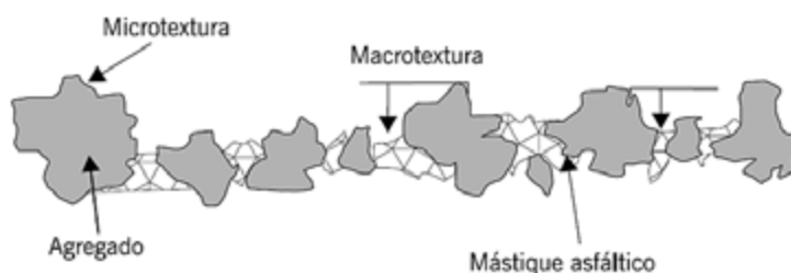
Figura 1. Representação da Microtextura e a Macrotextura (MATTOS, 2009).
