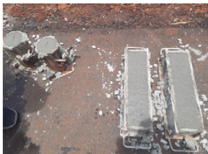
Figura 4 - Corpos de prova moldados pela WAY-112 no local da obra.
