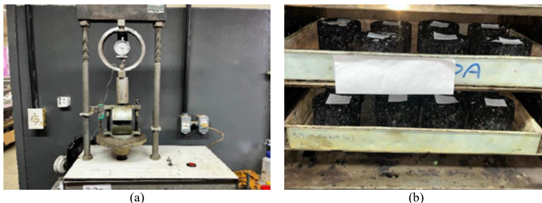
Figura 5. (a) Prensa automática; (b) Amostras compactadas.
