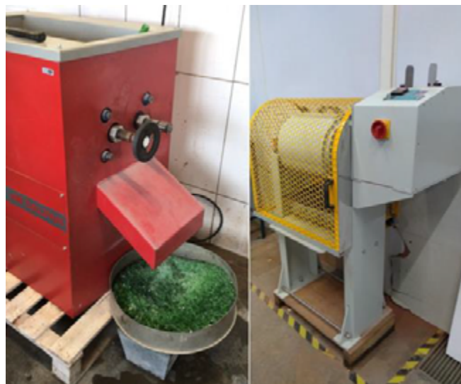
Figura 1. Equipamentos utilizados na trituração e moagem do vidro (AUTORES, 2024).
