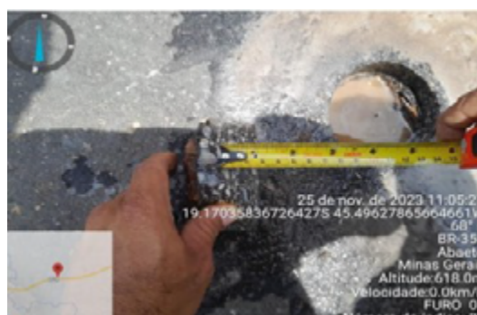
Figura 4. Controle da espessura dos corpos de prova com utilização de trena (OS AUTORES, 2023)
