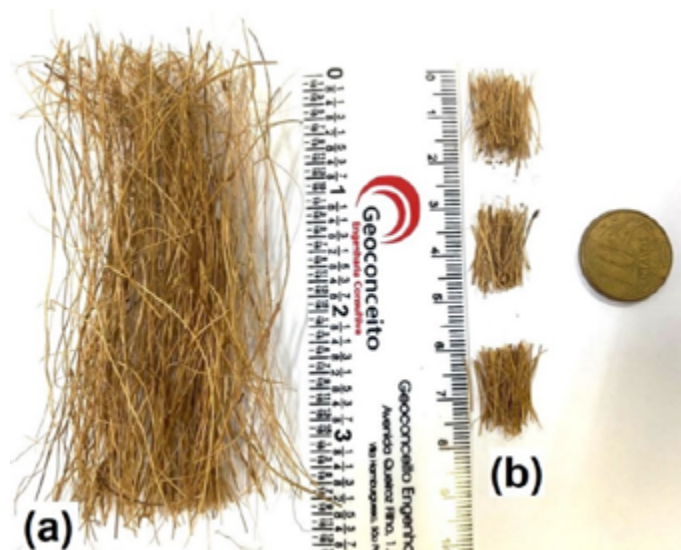
Figura 3. (a) Fibras de Coco antes de cortadas. (b) Fibras de Coco com 15 mm de comprimento (Autora, 2023).
