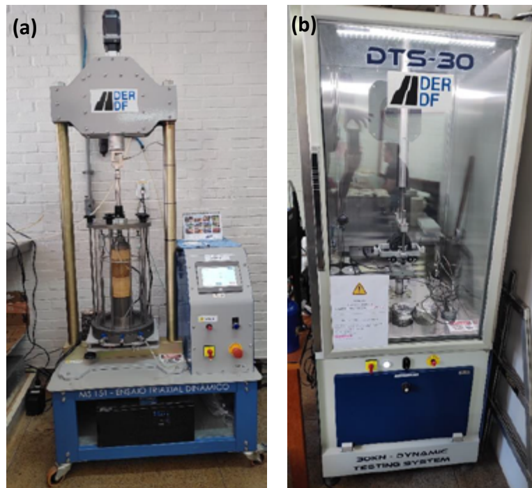
Figura 5. Equipamentos triaxiais dinâmicos do DER-DF: (a) solos e (b) misturas asfálticas.
