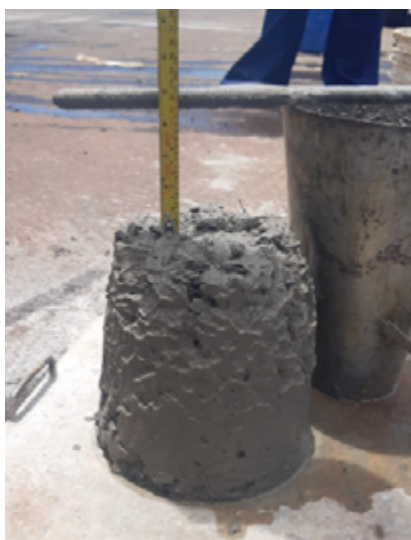
Figura 6 – Slump do concreto com fibra de PVA proveniente do segundo caminhão.
