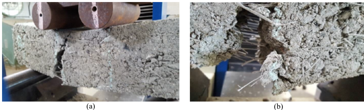
Figura 4. Evolução e detalhe do trabalho das fibras do ensaio de flexão em 4 pontos.
