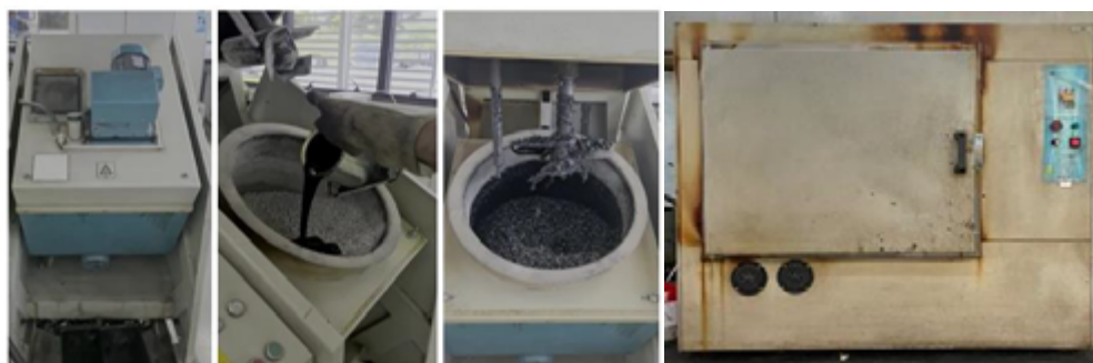
Figura 10 – Preparo da mistura asfáltica de CPA.
