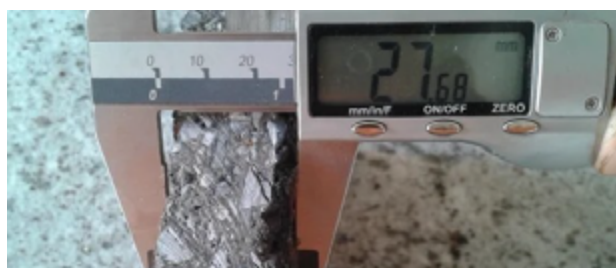
Figura 5. Controle da espessura dos corpos de prova com utilização de paquímetro digital (OS AUTORES, 2023)
