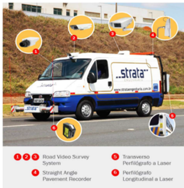
Figura 4 – Exemplo de veículo utilizado para coleta de dados de pavimento (STRATA ENGENHARIA, 2021)
