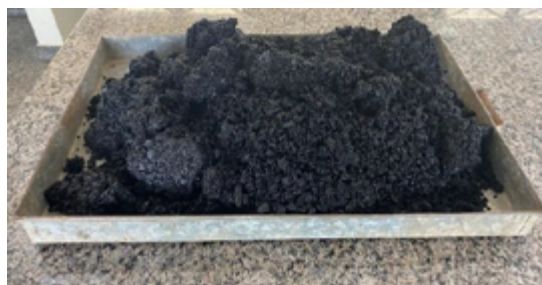
Figura 1. Concreto Asfáltico Estocável a granel (MOIZINHO, 2024).
