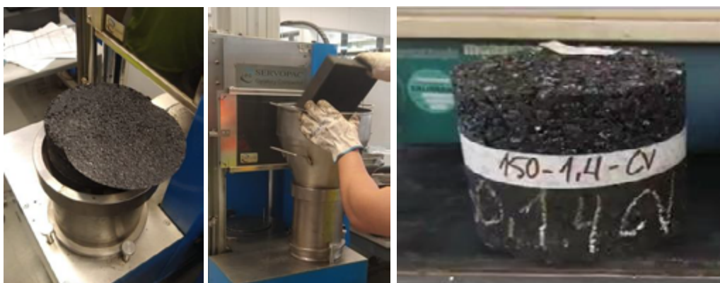
Figura 18 – Colocação do geotêxtil impregnado e compactação da segunda camada de mistura asfáltica em CPA.
