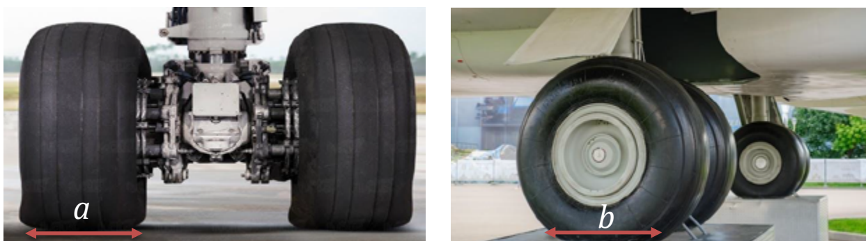
Figura 1. Medidas para área de contato entre pneu e pavimento (AUTORES, 2024).
