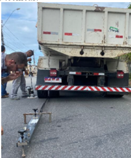
Figura 1. Realização dos ensaios de LWD e VB lado a lado (AUTORES, 2023)
